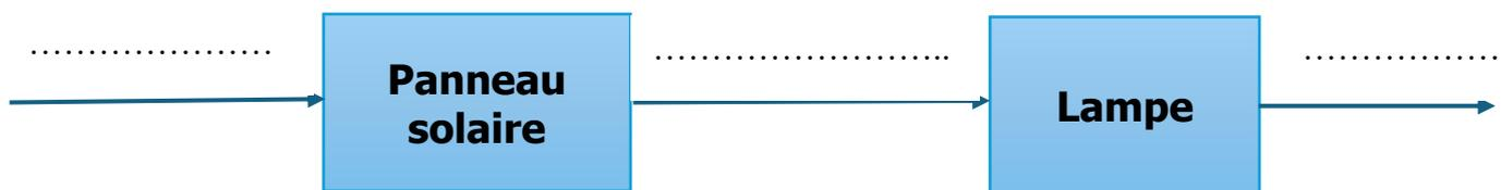
Une fois que tous les composants de l'objet technique ont été identifiés, on peut réaliser un schéma du parcours de l'énergie dans cet objet, appelé « **chaîne d'énergie** ». Ce schéma met en évidence le rôle et la fonction de chaque composant.
